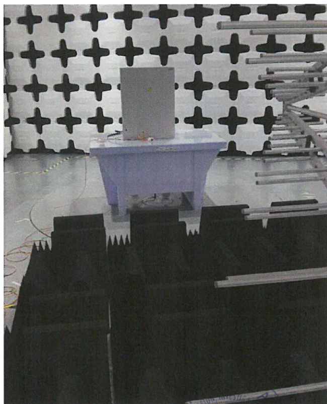
Disposición de la muestra para la realización del ensayo (80MHz – 1GHz).
